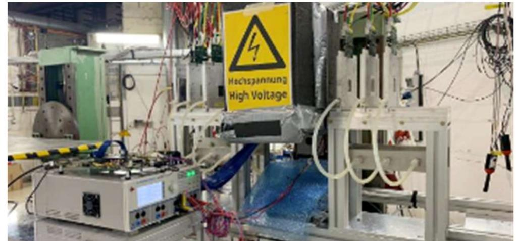
Tests en faisceaux du détecteur HGDT
